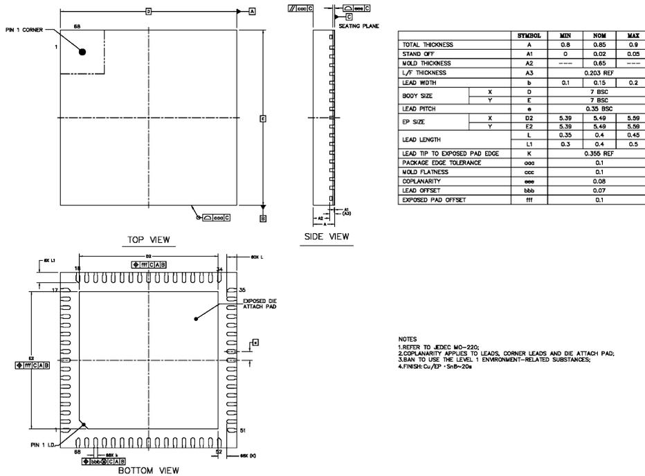
图 5-2: QFN68L 封装尺寸
