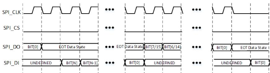
**图 3-9: Microwire 格式的多次收发时序**
