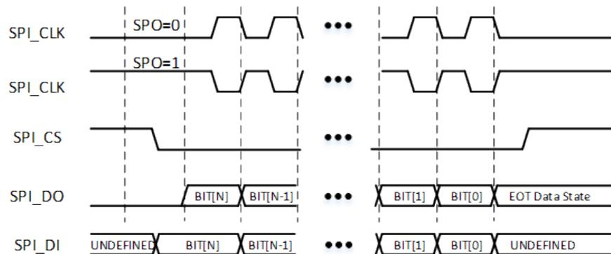
图 3-6: SPH=0 时的 SPI 时序
