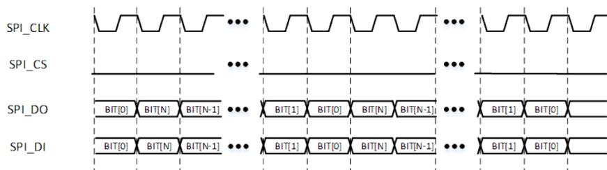
图 3-5: SPI 格式连续收发时序
