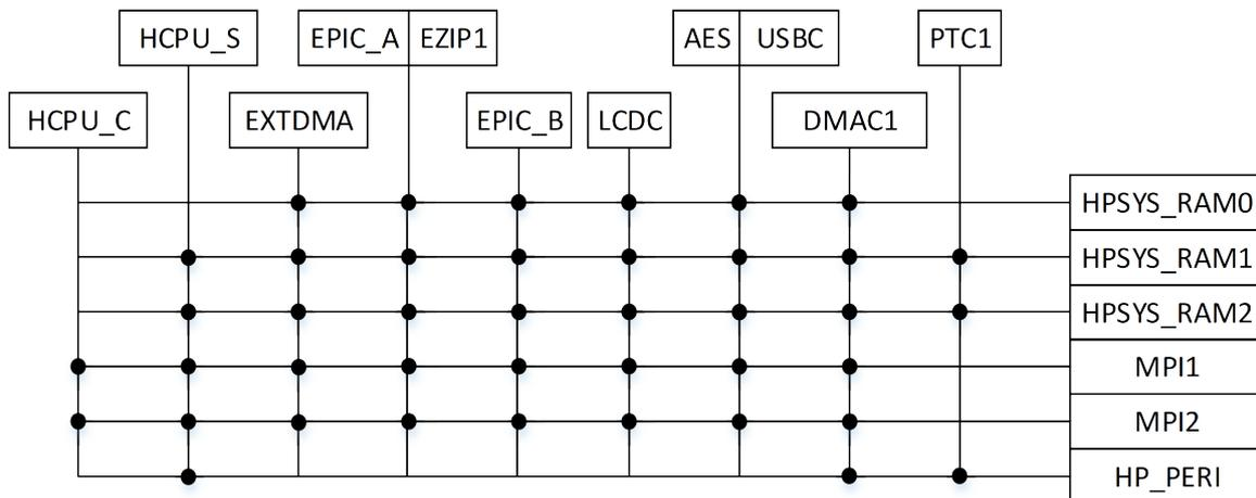
图 1-1: 性能处理器（大核）系统总线架构
