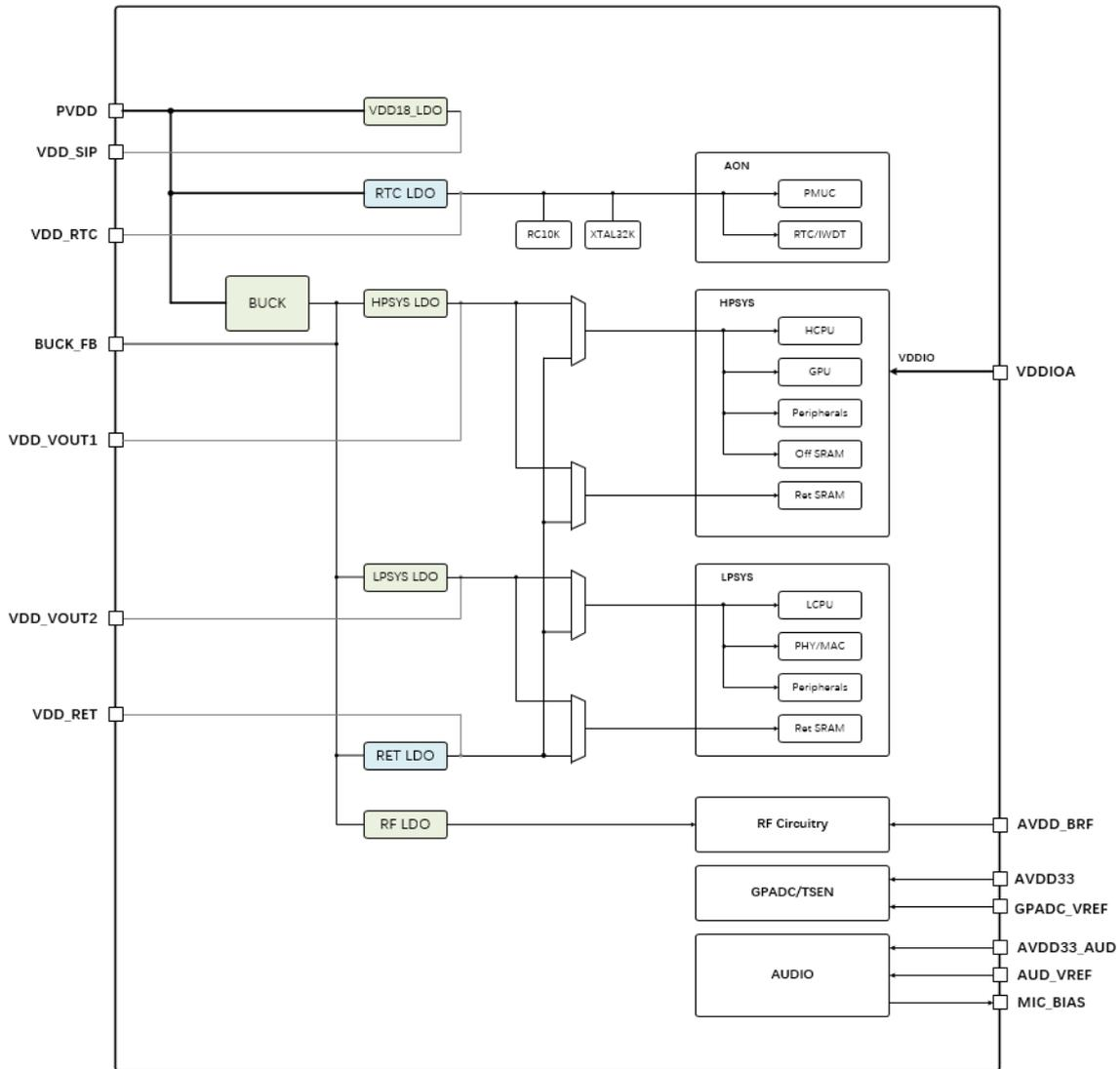
图 1-3: QFN 封装电源管理架构
