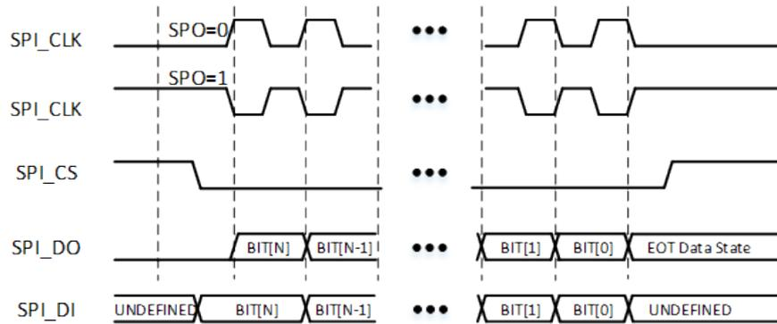
**图 3-7: SPH=1 时的 SPI 时序**
