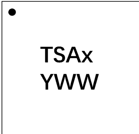
图 1-1: SF30147 WLCSP 封装 Top Mark 图
