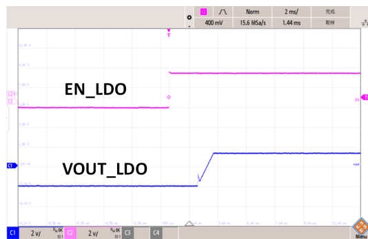
图 3-25: LDO 启动时间, LDO 负载电阻 33Ω
