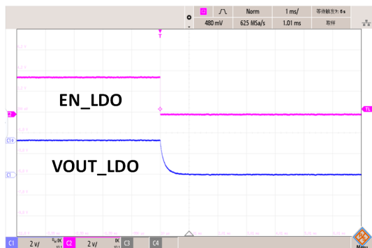
图 3-26: LDO 关断时间, LDO 负载电阻 33Ω
